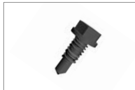
12. Саморез 6,3×25 мм по металлу для панелей ворот
