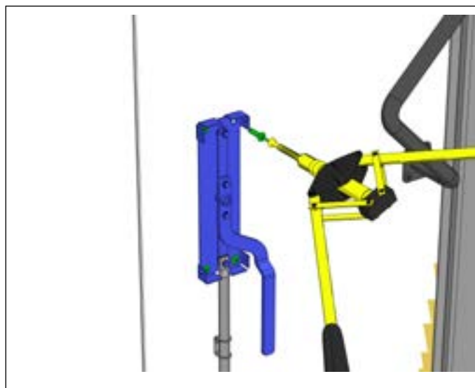
Прикрепите механизм задвижки заклепками при помощи клепателя.
