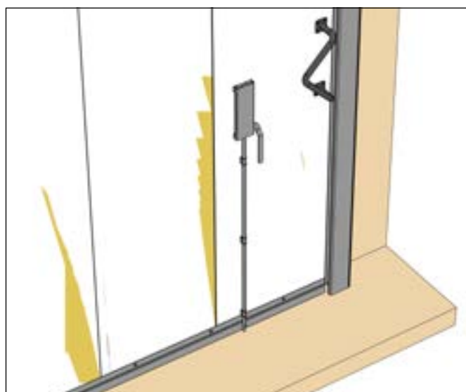
Установите механизм задвижки на расстоянии 1 200 мм от нижней части полотна.
